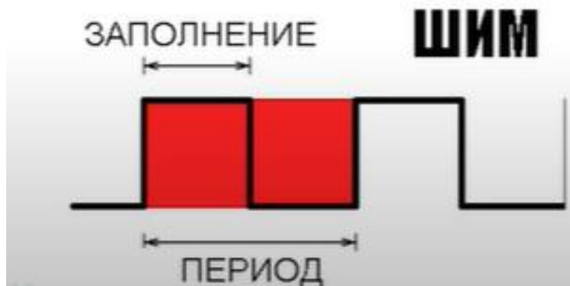
Рис. 2. Импульсный сигнал, получаемый с помощью ШИМа
