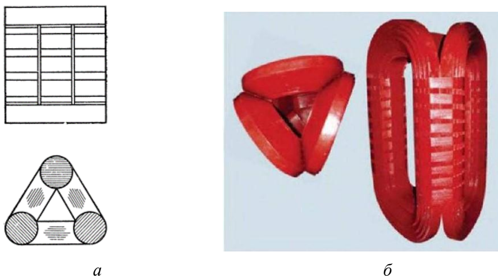
Рис. 4. Пространственные магнитные системы: а – стыковая; б – навитая
