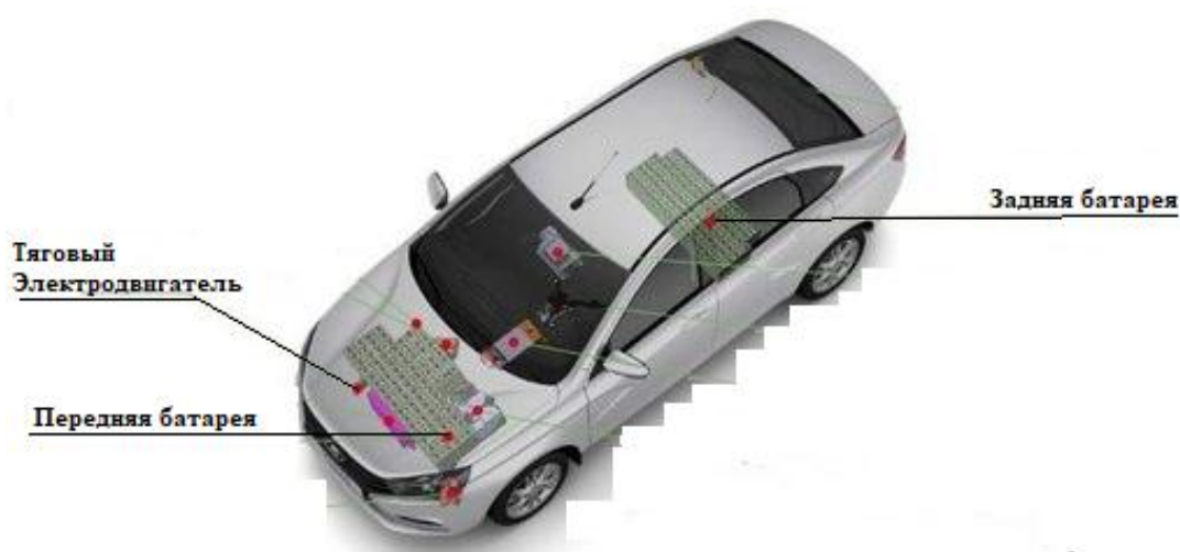
Рис. 1. Схема расположения силовой установки электромобиле Lada Vesta EV
