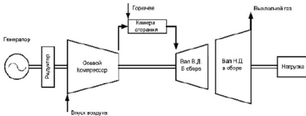
Рис. 2. Структурная схема газоперекачивающего агрегата
