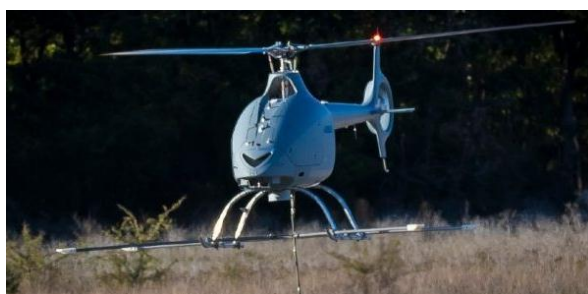
Рис. 3. Беспилотный вертолет компании Airbus VSR700 с дизельным двигателем
