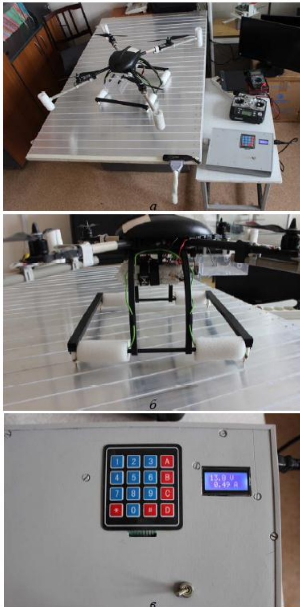
Рис. 3. Экспериментальный образец платформы: а – общий вид; б – бортовые контакты БЛА; в – пульт управления
